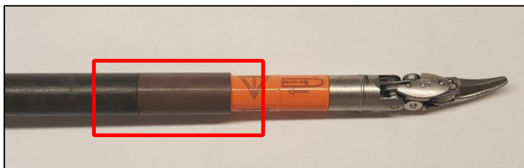
Figure 1. MCS da Vinci S/Si EndoWrist avec mise en évidence de l'extrémité proximale du tube d'extension.
